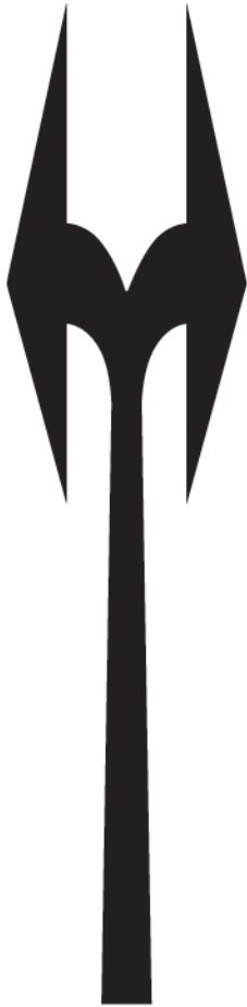
Richtungspfeil - Radweg, links und rechts Pfeillänge: 2000 mm, 2500 mm
