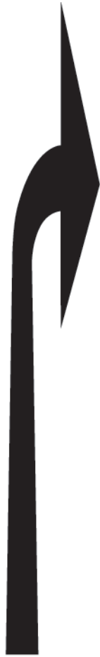
Richtungspfeil - Radweg, Rechtsabbieger Pfeillänge: 2000 mm, 2500 mm
