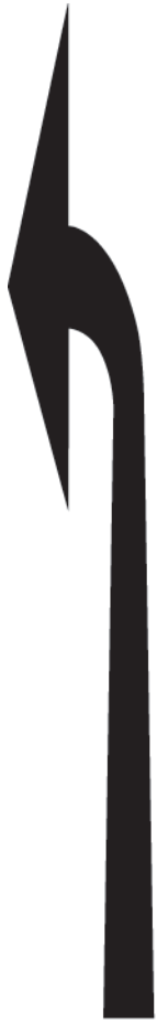
Richtungspfeil - Radweg, Linksabbieger Pfeillänge: 2000 mm, 2500 mm
